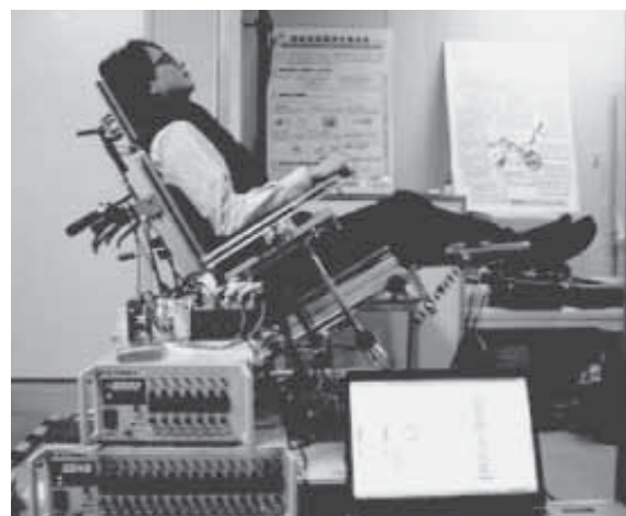
姿勢保持機能試験の方法開発 （各種姿勢を保持したときの荷重測定）
